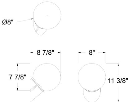
Tous les composants des luminaires SNOC sont fabriqués à partir de l'alliage d'aluminium A-356 ou A-413 incluant moins de 0,2 % de cuivre et résistant à l'oxydation.
