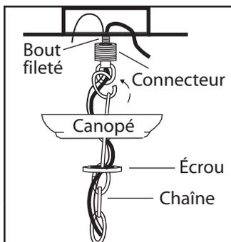
8. Dévissez l'écrou sur le connecteur supérieur et glissez-le vers le bas de la chaîne au connecteur inférieur. Glissez la plaque sur la chaîne vers le connecteur inférieur. Passez le fil à travers l'écrou, la plaque, le connecteur supérieur et sur le mamelon. Serrez le connecteur supérieur sur le mamelon. Écartez l'autre bout de la chaîne et attachez au connecteur supérieur. Fermez le maillon.
