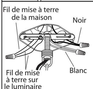
9. Brancher les fils de la mise à terre (cuivre nu ou vert) de votre luminaire au fil de la mise à terre (cuivre nu ou vert) ou vis de la mise à terre dans la boîte électrique. Poser le fil noir (ou fil marqué "SPT-1") de la fixture au fil noir dans la boîte électrique et poser le fil blanc (ou le fil rainuré) de la fixture au fil blanc dans la boîte.
