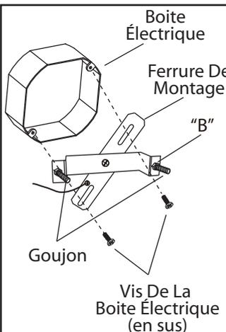
**1.** Dévissez l'écrou B. Ajustez le poteau à la longueur désirée et barrez en place avec cet écrou.
